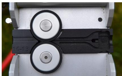
Las placas adaptadoras NanoFlow MAX y la rueda de acero MAX se aplican para microcables de 3,0-4,5 mm.
