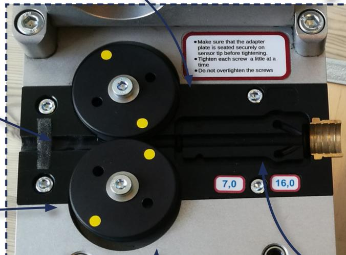
Las juntas MicroFlow V5 están disponibles en diferentes tamaños para conductos de diámetro externo de 4-16 mm y fibra / cable de 0,8-6,5 mm.
